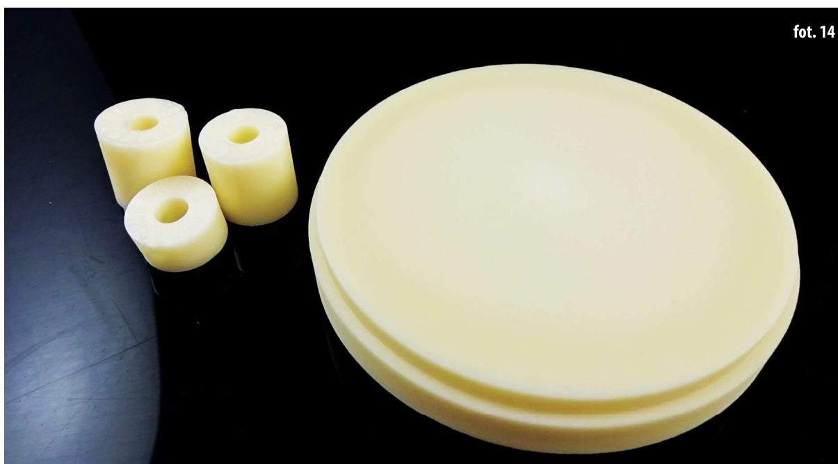
▲ fot. 14. Acetal w walcach do iniekcji i krążek do systemów otwartych CAD/CAM
