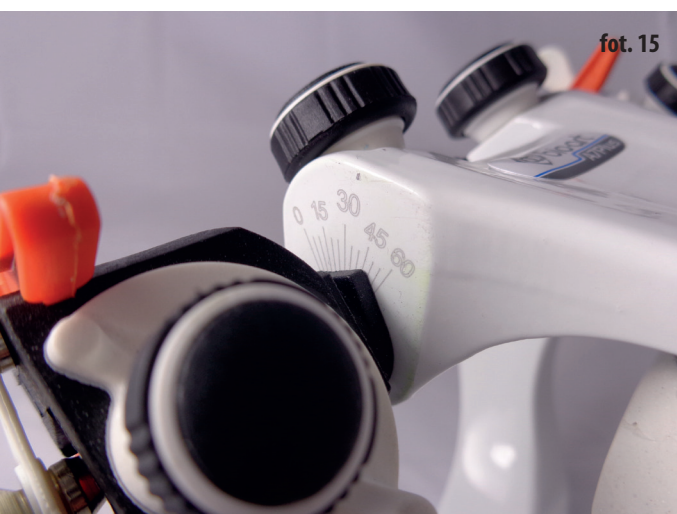
▼ fot. 15. Głowica artykulatora – prowadzenie 45
