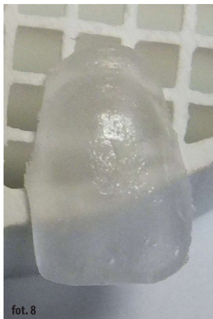
▼ fot. 8. Wynik testu – temperatura wypalania – niższa od planowanej
