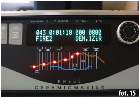
▲ fot. 15. Wieloetapowy, pełny program wypalania porcelany Tressis na cyrkonie
