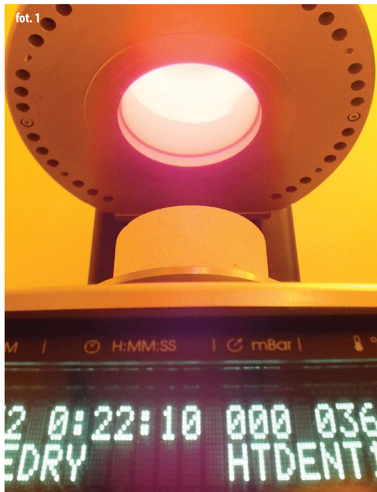
▼ fot. 1. Komora termiczna pieca do wypalania ceramiki
