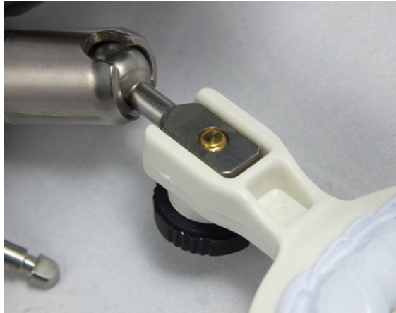
Fot. 6. Śruba kątowna blokująca transfer w Łuku Elite
