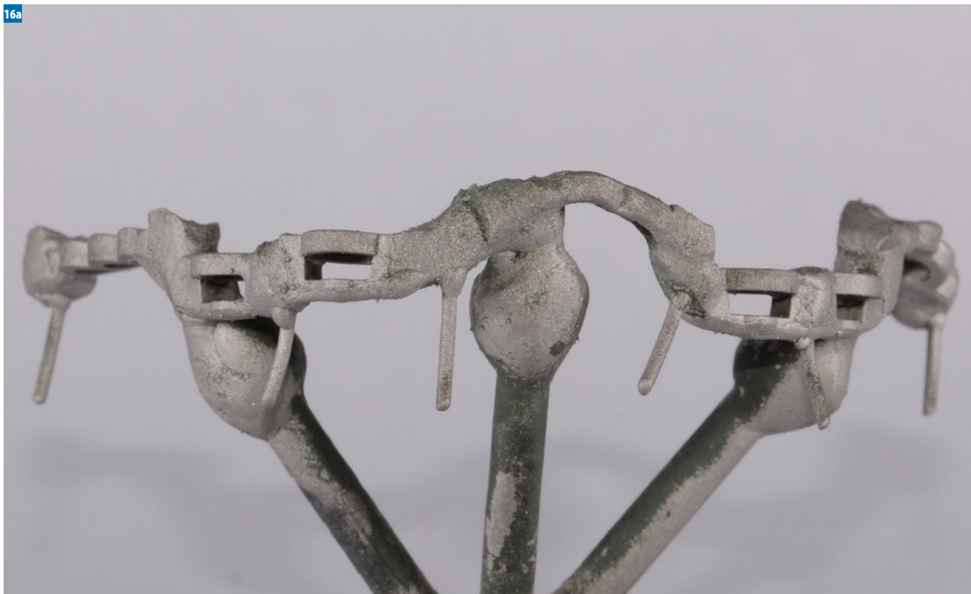
Fot. 16a. Odlana konstrukcja wzmocnienia
