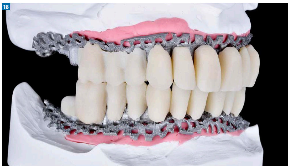
Fot. 18. Montaż zębów kompozytowych – odcinek boczny – korony zespolone
