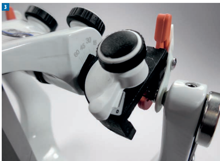
Fot. 3. Głowice artykulatora ustawione w pozycji do artykulacji modeli – zamki górnego ramienia w pozycji zamkniętej, kąt Bennetta 0°
