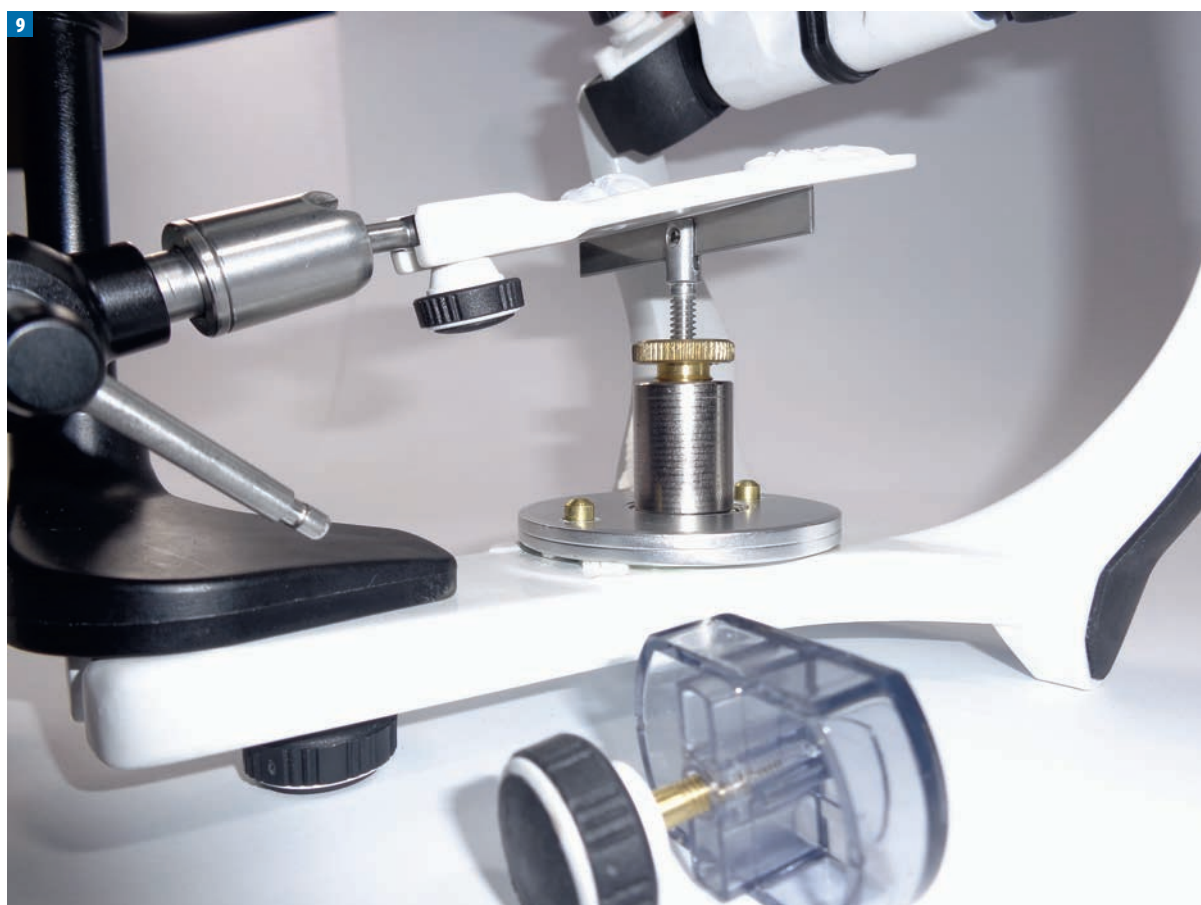
Fot. 9. Podpórka widelca zgrzyzowego do stabilizacji układu przenoszenia danych
