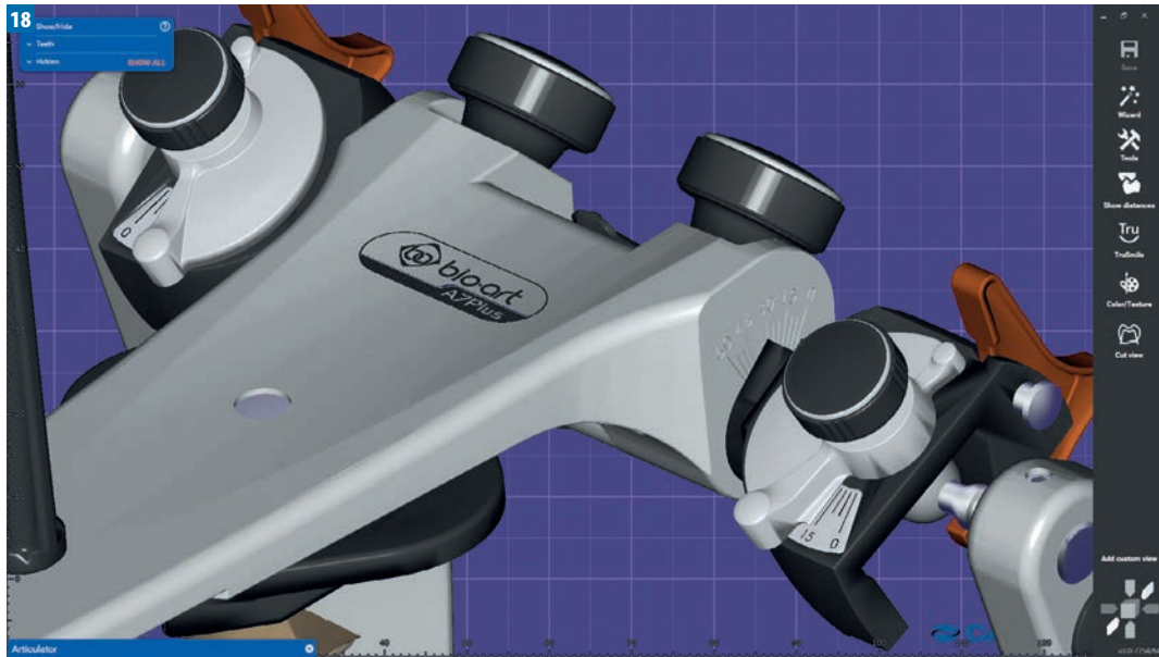
Fot. 18. Głowice artykulatora wirtualnego Bio-art A 7 Plus (Exocad)
