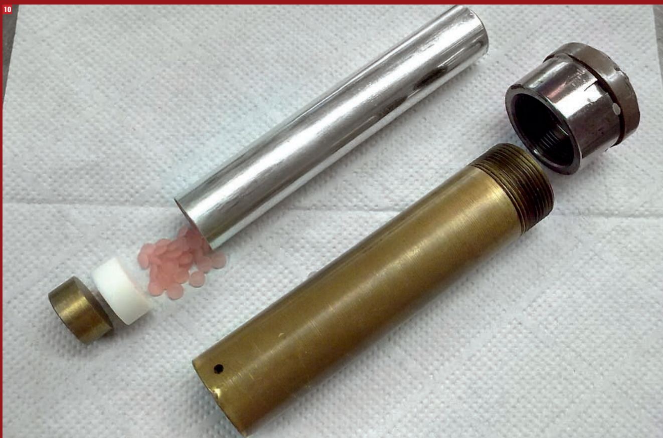
8 Proteza woskowa górna z kanałami wtryskowymi przygotowana do zalania kontry 9 Przygotowana forma wtryskowa z naniesionym lakierem Gyplux 10 Elementy naboju wtryskowego
