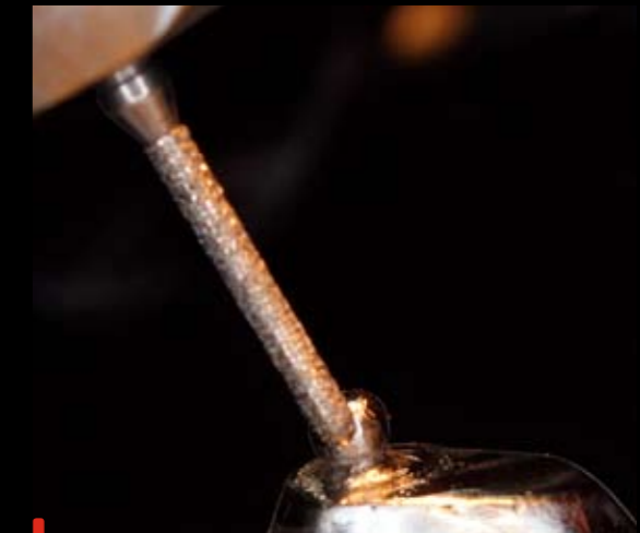
Zdj. 20. Delikatnie przesuwane po obwodzie, aby zmniejszyć średnicę, ale zachować kształt walca
