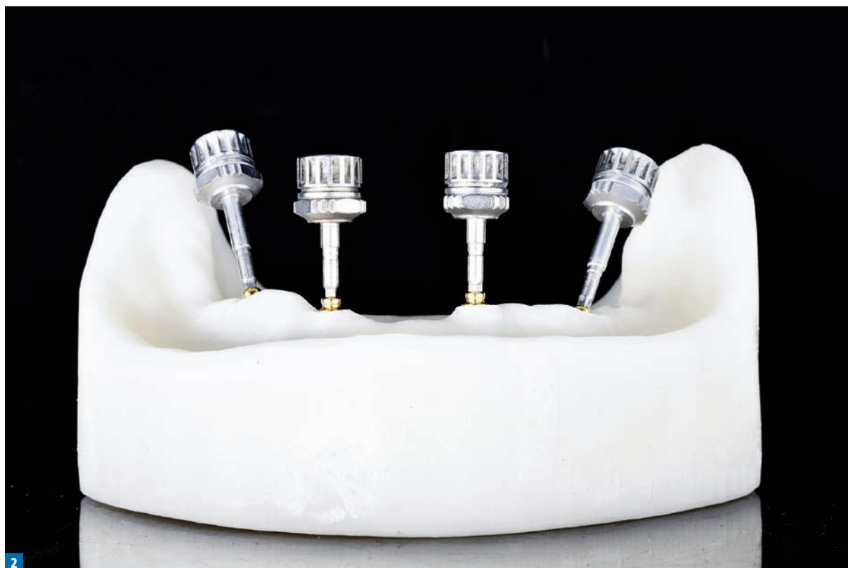
Fot. 2. Model testowy B – znaczna rozbieżność analogów implantów
