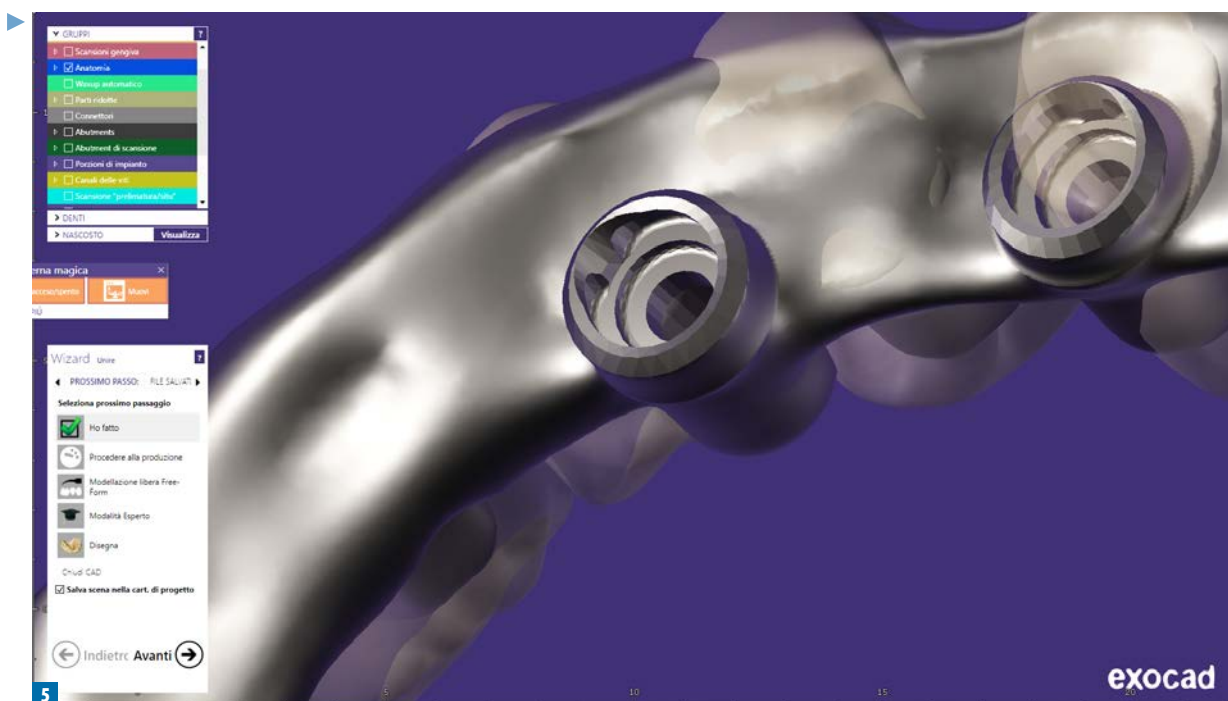
Fot. 5. Połączenie OT-Bridge z gniazdem na pierścieniu acetalowy Seeger
