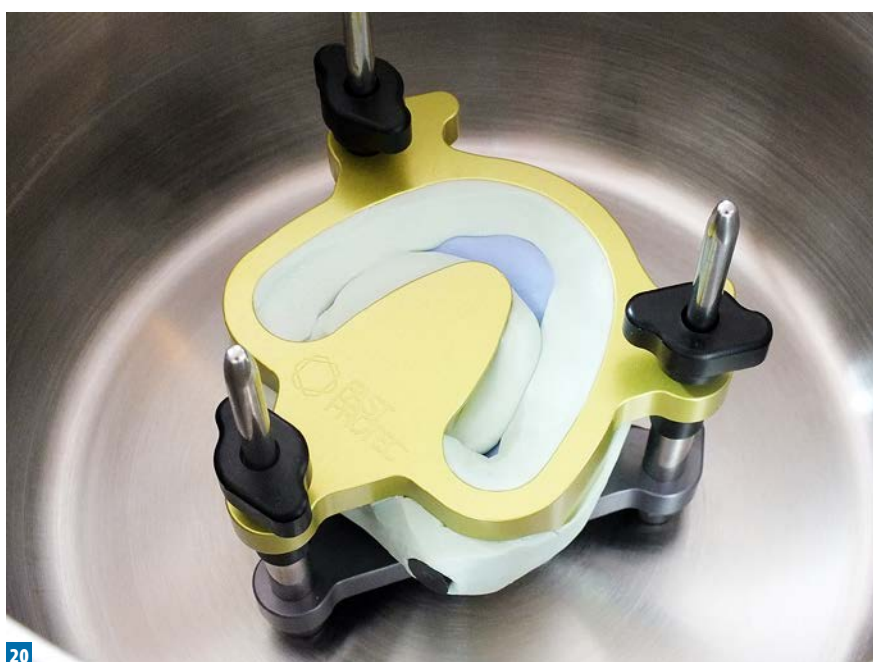
Fot. 20. Klucz dopełniający z wertykulatorem w komorze nadciśnieniowej – II faza – stabilizacja 4 min (2,5 bar)
