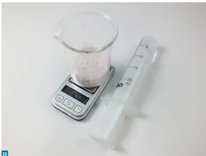
Fot. 25. Prawidłowo przygotowana proporcja polimer i monomer akrylu mikroperłkowego
