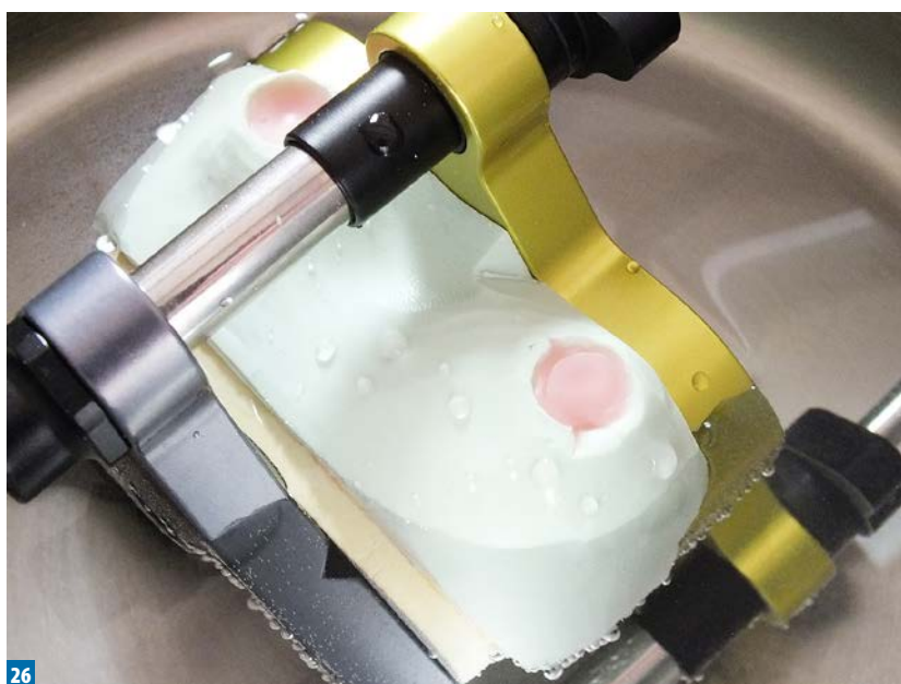
Fot. 26. Wertykulator w polimeryzatorze – poziom wody o temp. 45°C do wysokości modelu
